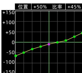
特技1 的螺距曲线的点1、2、3、4 基本和普通的设定值相同，和悬停设定不同的是：高位时发动机（电
