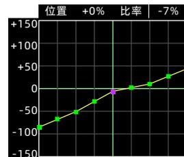
高位螺距的设定和特技1 的设定相同。曲线如图进行设定。
