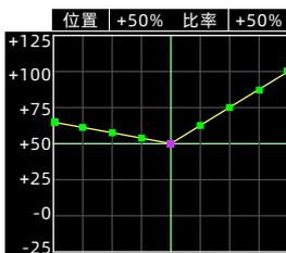
此设定可以让摇杆在低位时，发动机（电机）仍保持急速运转。
