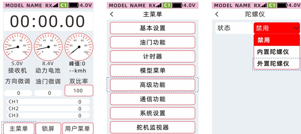
陀螺仪：如果陀螺仪，只需要旋钮调节感度的功能，可在通道功能，DL、VR，分配陀螺仪接口通道。
