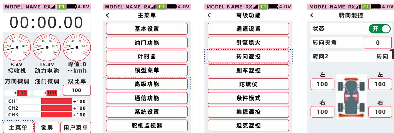
注意：转向混控功能开启后，通道4仅作为转向混控方向2的输出，【通道设置】中的通道4功能设置将无效。
