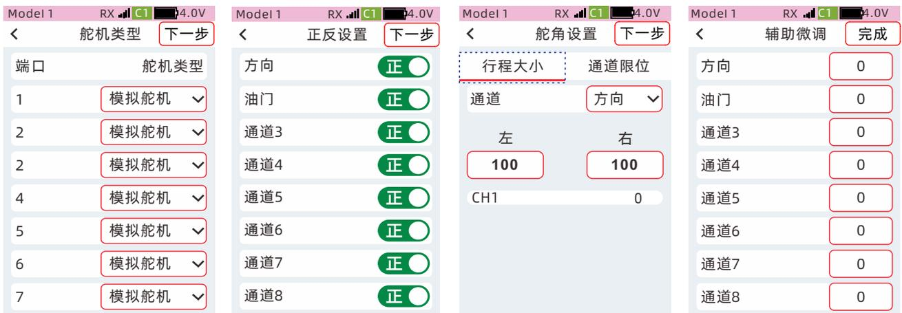
功能步骤：【对码】→【舵机类型】→【正反设置】→【舵角设置】→【辅助微调】
