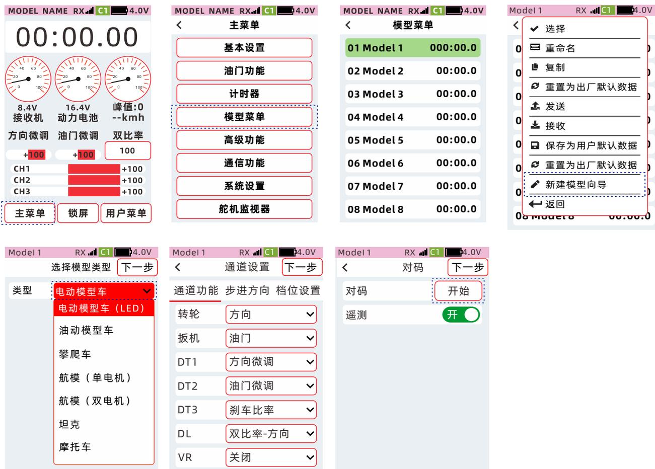
功能步骤：【新建模型向导】→【选择模型类型】→【通道设置】→【对码】
