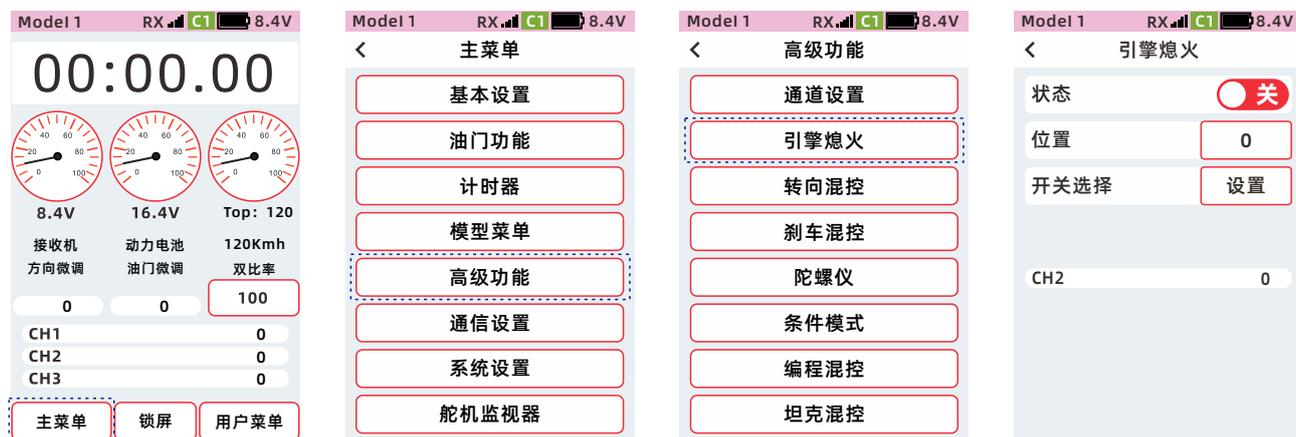
提示：当【油门功能】-【油门模式】设置为【前进100：刹车0】；【前进50：刹车50】的设置为刹车输出量，由于无刹车功能。【位置】的设置值无论为任何值，输出均为油门通道在中立点时，油门通道的输出量。需要通过【基本设置】【舵角设置】【行程大小】中的行程量和【微调设置】中的微调量调整引擎熄火的位置。
