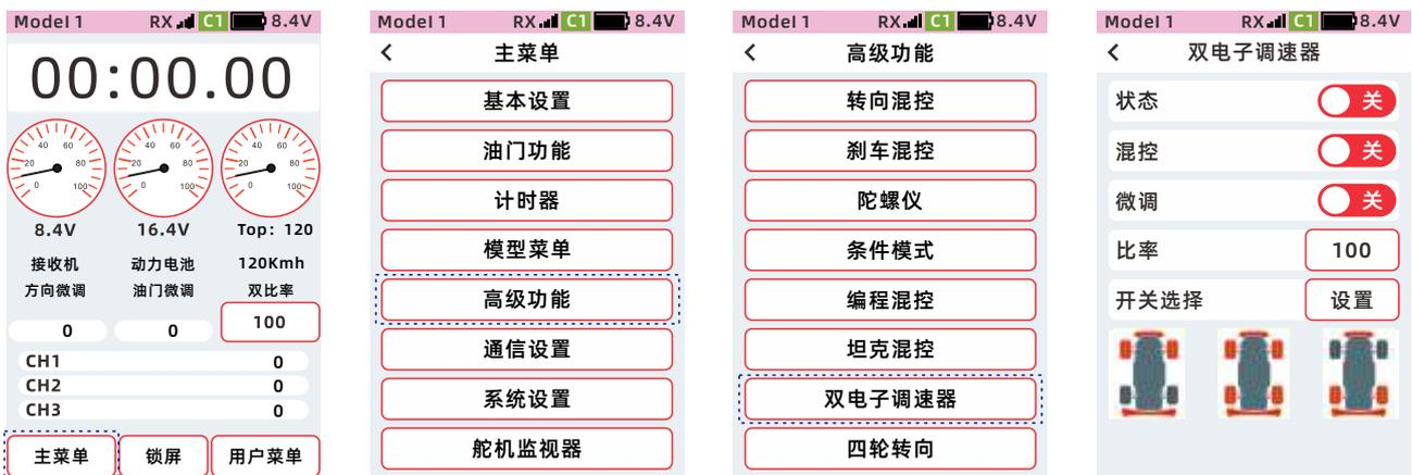
注意：双电子调速器功能开启后，通道4仅作为电调2的输出，【通道设置】中的通道4功能设置将无效。
