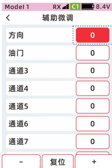
\*提醒：请参照模型套件的说明书，安装好机械机构，接收机通电，发射机设置舵机通道正反，并尽可能使舵机摇臂接近中点位置，再通过【辅助微调】调节舵机摇臂中心点【舵机中点或偏左偏右】。
