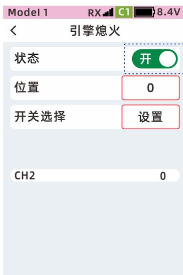
\*如果模型为电动设备，同样可以使用【引擎熄火】实现油门锁定功能。
