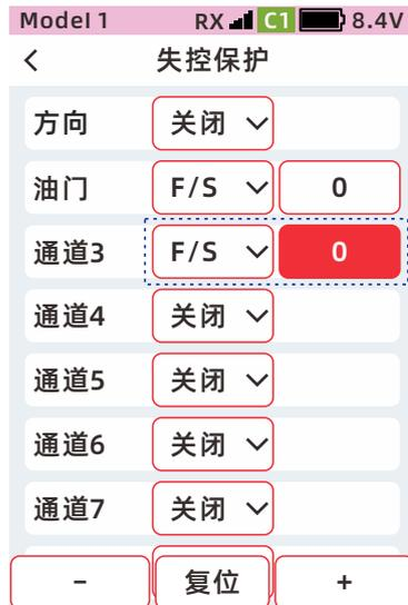
注意：失控保护数值是通过接收机保存，进入【失控保护】菜单之前，先给接收机通电。可以读取到接收机已设置的失控保护参数。
