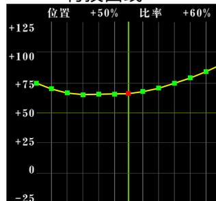
悬停油门微调是在悬停点附近的油门微调功能。通常在悬停的条件下使用。伴随温度、湿度等条件的变化，旋翼转数也会发生变化，悬停螺距曲线可针对这些变化进行微调，令旋翼转数保持最稳定的状态。另外，和悬停螺距微调功能并用，可以进行更为细致的微调。
